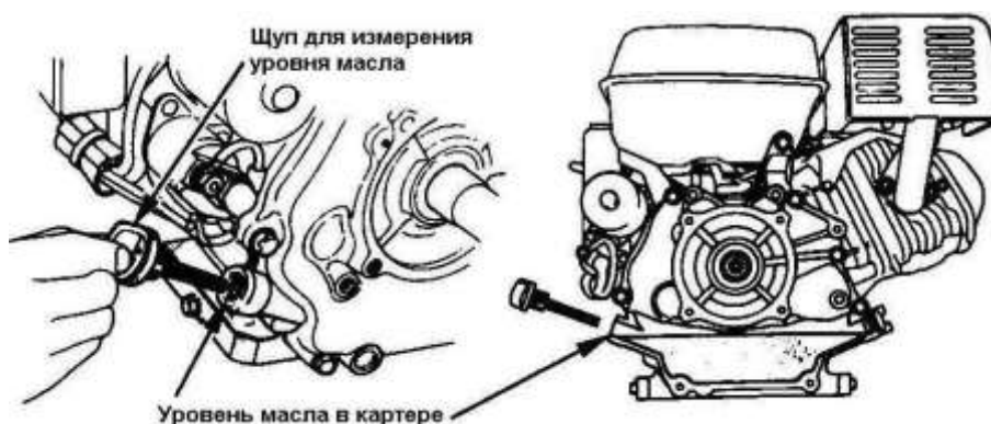
Рисунок 2 – Уровень масла в картере двигателя
